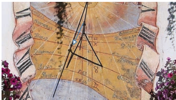
Abb. 3 – Sonnenuhr Marxnhof, Oberperfuss. Stunden- und Datumslinien. Hier zeigt der Stabschatten also zwei Uhr wahre Ortszeit an. Der zusätzliche Kugelschatten markiert das Datum (kurz nach) 23. Sept.
